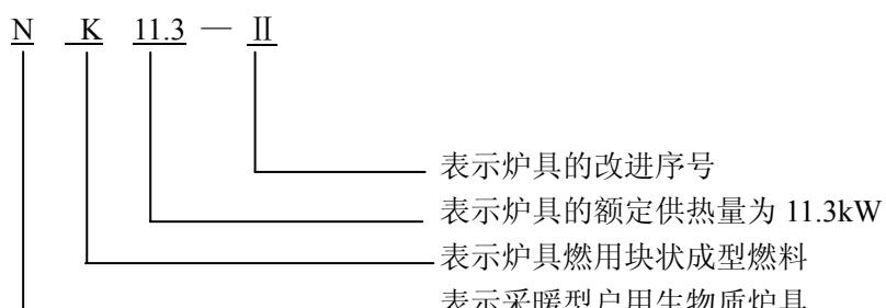
表示该炉具是采暖型燃用生物质块状成型燃料的II型户用炉具，额定供热量为11.3kW。
